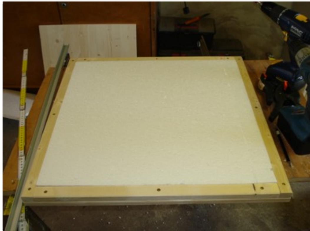
In den Rahmen passen wir jetzt die Styroporplatte ein. Die Platte sollte straff sitzen um eine gute Dämmwirkung zu erzielen. Als nächstes kommt eine weitere Leimholzplatte als „Deckel“ oben drauf und wird verleimt und verschraubt.
