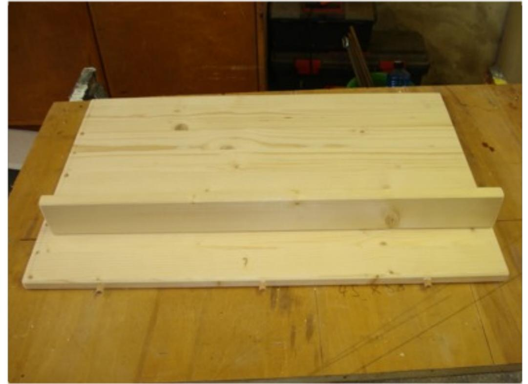
Jetzt versehen wir noch die unteren Kanten aller 3 Seitenteile mit Dübeln. Diese werden später auf die Bodenplatte übertragen.
